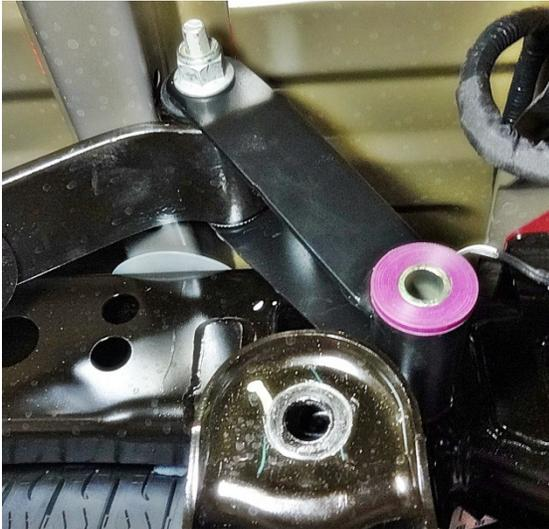
A. INSTALL THE NEW DROP SHACKLE OVER THE REAR LEAF SPRING EYE WITH THE OPEN END OF THE SHACKLE TOWARD THE FRONT.
