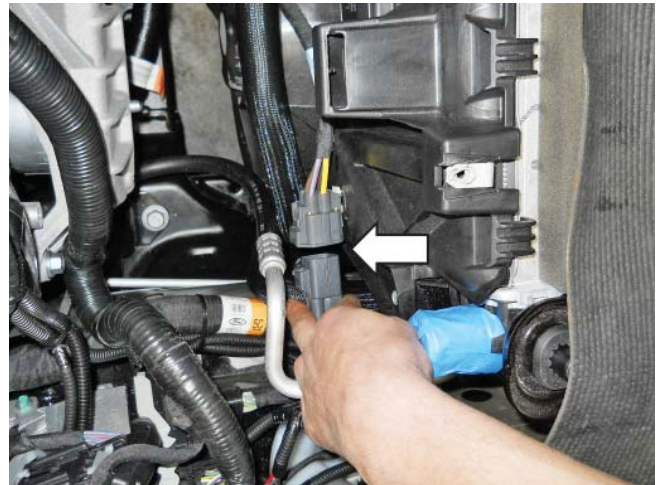
Fan electrical connector
